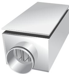
**Artikel-Nr.** 200FIKAF7**Beschreibung** Mit Grobfilter G4 und Feinfilter F7 mit Wechselrahmen. Wärmebrückenfrei isoliert. Isolierstärke 50 mm.**Abmessungen**Anschluss-Ø: DN 200
