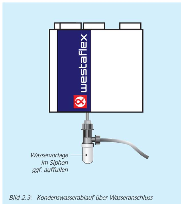
Bild 2.3: Kondenswasserablauf über Wasseranschluss
