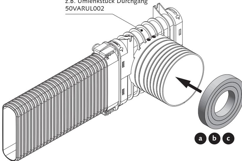
1. Elemente aus der Drossel nach gewünschter Luftmenge von Hand entnehmen
