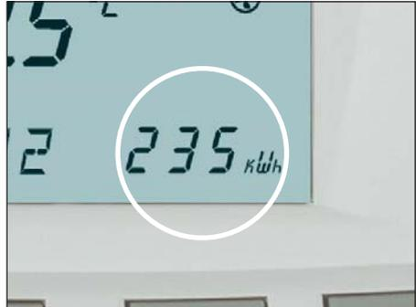
Bei montiertem Bypass wird die bisher eingesparte Energie in kWh angezeigt.
