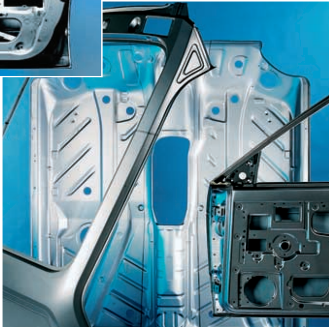
Abb. 5: Karosserieteile, zum Teil lasergeschweißt, aus feuerverzinkten Feinblechen
