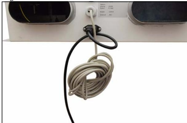
Zum Anschließen eines Bedienteiles ist ein max. 20 m langes Steuerkabel (IY(ST)Y 2 x 2 x 0,6 mm) erforderlich.
