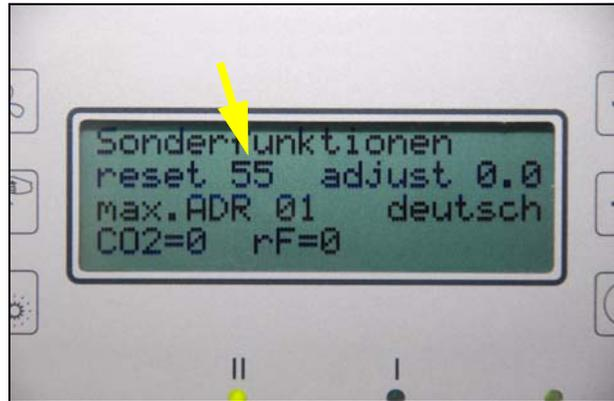
Mit der *Reset*-Funktion kann das Bedienteil in den Auslieferungszustand zurückgesetzt werden. Achtung: Bei einem Reset gehen alle eingestellten Werte, Schaltprogramme, Datum, Uhrzeit, und Adjust verloren.
