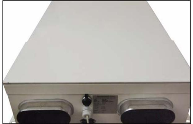
Der Deckel ist an das Außengehäuse mit nach innen versetzten Schrauben angeschraubt. Die zehn Befestigungsschrauben können nur mittels Werkzeug geöffnet werden. Die Schrauben und der Filtereinschub werden durch gegenüberliegende bewegliche Filterklappen verdeckt. Die Filterklappen sind innen mit Wärmedämmung versehen und über Reibverschlüsse zu öffnen.
