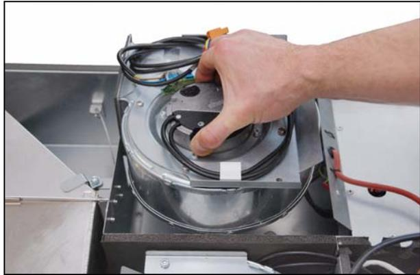
Die Montage des neuen Ventilators erfolgt sinngemäß umgekehrt. Nach der Montage:
