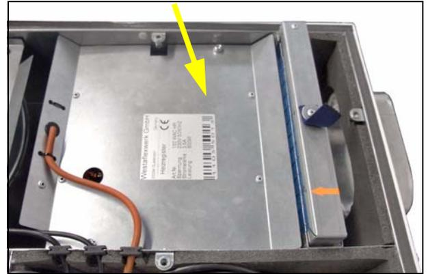
Ist ein Vorheizregister eingebaut, wird die Frischluft über ein elektrisches Vorheizregister vorgewärmt. Das Vorheizregister wird eingeschaltet, wenn die Frischlufttemperatur den Parameter "Vorheizen Ein" unterschreitet. Gleichzeitig wird eine einstellbare Zykluszeit gestartet. (Auslieferungszustand 8 Minuten). Steigt die Frischlufttemperatur über den Parameter "Vorheizen aus" schaltet das Vorheizregister ab.
