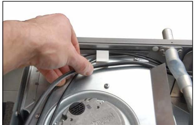
Motorkabel in den Schlitz stecken
